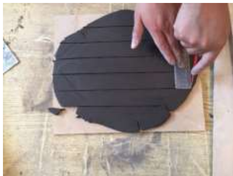
Imagen 69. Recorte de una tortilla para obtener losetas para pruebas del barro siena de Casas Grandes, Chih.
