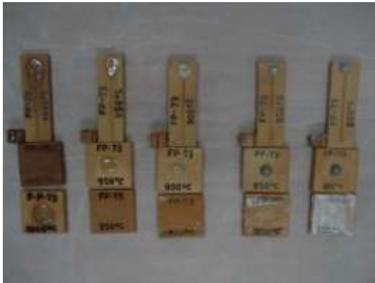
Imagen 20. Pruebas de la frita Pedro 73, de un ex alumno del profesor Uriel Aréchiga, elaborada en la visita del 27 de mayo de 2010, los compañeros Moisés Ramírez y Domingo Martínez hicieron muestras para probar el escurrimiento, la tensión superficial y la apariencia a 800°C, 850°C, 900°C, 950°C y 1000°C.
