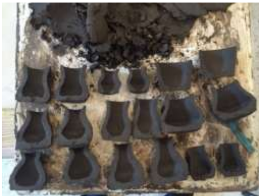
Imagen 68. Probetas realizadas en torno de mano y cortadas a la mitad para el segundo estudio de una arcilla siena de Casas Grandes, Chih.
