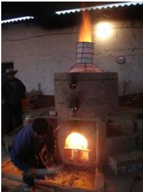
Imagen 21. El ingeniero Moisés Ramírez Zambrano, el 15 de octubre de 2010 en la parte final de la quema recoge leña para echarla a la boca de fuego del horno. Se comentó que hubo desperdicio de energía, se propuso cerrar el cilindro de la chimenea a la mitad, la entrada de aire del cenicero y el deflector de la salida de la chimenea.
