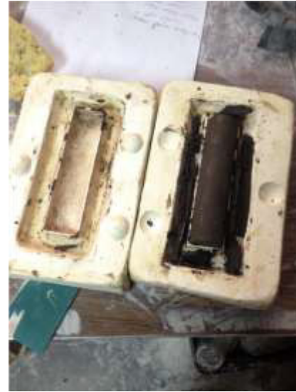
Imagen 59. Molde para producir tubos porosos, estudio del diseñador industrial ceramista Erik Ordaz.
