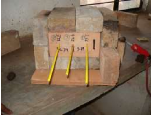
Imagen 5. Horno improvisado con tabiques para medir el ritmo de calentamiento de tabiques refractarios hechos en el Ceforcal por el ingeniero Moisés Ramírez Zambrano, supervisado por el profesor Uriel Aréchiga V., 24 de enero de 2009.
