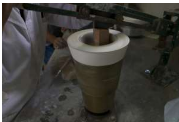
Imagen 56. Formado del prototipo de la taza cuadrada redonda de la vajilla Zautla.
